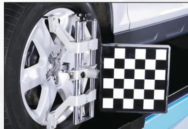
Специальные измерительные мишени типа «шахматная доска». Корпус выполнен из легкого сплава с пластиковым защитным бампером, небьющийся рисунок стоек к истиранию. Надежное, проверенное временем решение без электроники, проводов и аккумуляторов.
