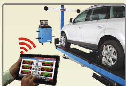
Программное обеспечение стендов позволяет использовать планшет на базе ОС Android как пульт дистанционного управления стендом. Помимо управления функциональными клавишами на экран также выводятся диаграммы, что позволяет использовать планшет при регулировках автомобиля в местах где обзор монитора затруднен.
