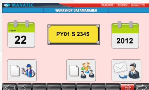
Программное обеспечение стендов ведет архив выполненных работ на стенде, и позволяет легко извлекать отчет по проведенной регулировке углов установки колес по дате, регистрационному знаку автомобиля, или фамилии оператора. Доступно резервное копирование информации для предотвращения потерь.
